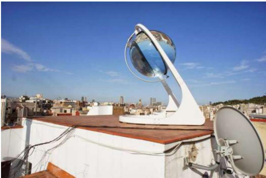
Инновационная технология, направленная на повышение эффективности использования солнечной энергии. Батарея представляет собой сферическую емкость, заполненную специальной жидкостью. При этом поверхность сферы обтянута теплоулавливающими панелями. Исследования показали, что Betaray в четыре раза эффективнее традиционных солнечных батарей.
